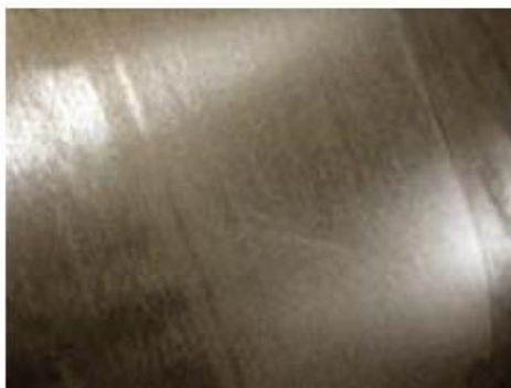
Les surfaces en acier inoxydable forment une couche gris/noir pendant le laminage ou le formage à chaud. Cette couche d'oxyde tenace est enlevée par décalaminage.
