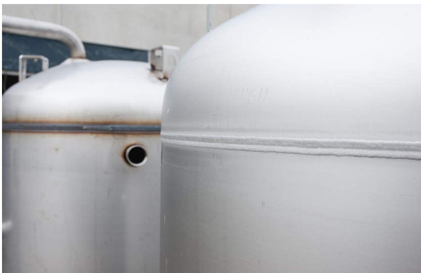
Vergelijking tussen twee tanks, de achterste voor behandeling, de voorste na behandeling
