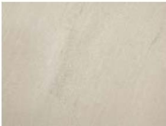
Un gris mat reste sur les produits recuits après le décalaminage et le décapage. La rupture de la couche d'oxyde rend la surface rugueuse.
